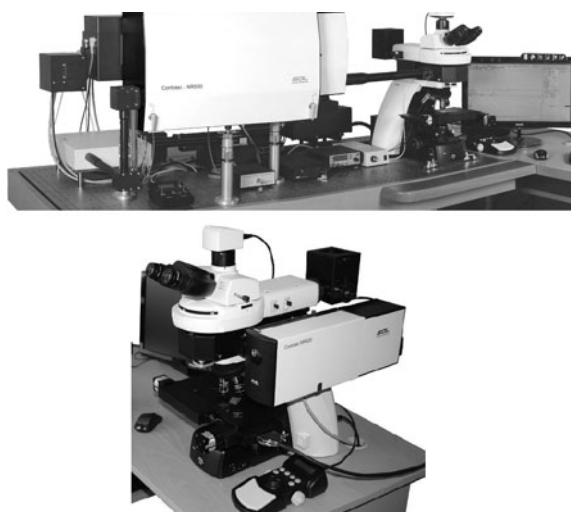
Рис.1. Сканирующие конфокальные рамановские микроскопы Confotec®: (NR и MR серии).
