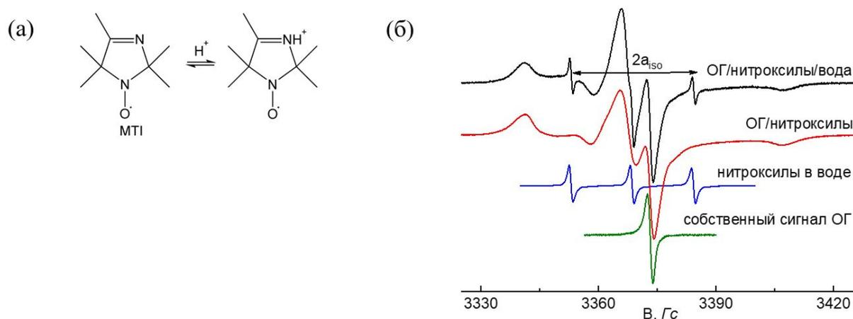
Рисунок 1. (а) pH-чувствительные спиновые зонды МТИ; (б) Спектр ЭПР образца оксида графита (GO), содержащего спиновые зонды МТИ и воду (черный); спектр ЭПР образца сухого оксида графита, содержащего спиновые зонды МТИ (красный); спектр ЭПР раствора зондов МТИ в воде (синий); спектр ЭПР порошка оксида графита (зелёный).
