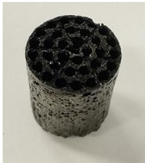
Рис. 1. Внешний вид углеродного блочного изделия
