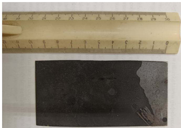
Рис. 1. Покрытие, полученное методом химической сшивки частиц МГ на подложке из стали.
